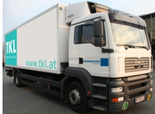
TKL LKW für die Feinverteilung mit einem variabel verschiebbaren Zwei-Kammersystem für unterschiedliche Temperaturbereiche (Fotorechte TKL Supply Chain)
